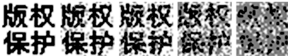
(a) 二值水印 (b) 12.5%灰色的三值水印 (c) 25%灰色的三值水印 (d) 50%灰色的三值水印 (e) 75%灰色的三值水印
